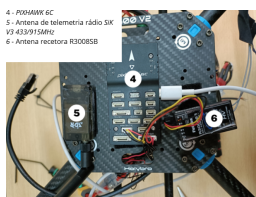
Figura 9: Imagem legendada dos componente da plataforma do UAS
