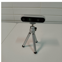
Figura 4: Câmera Intel Real-sense D435i
