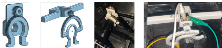
Figura 4: Modelação 3D e aplicação real do manche
