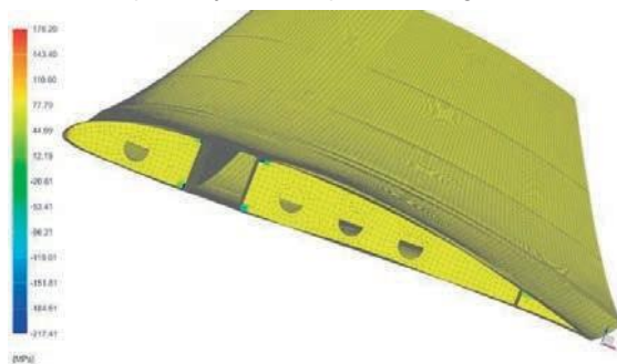
Figura 14: Tensões máximas Von Mises registadas na asa.
