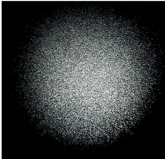
Fig. 1. Imagem de um padrão speckle obtido na extremidade da POF
