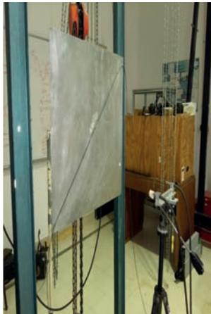
Fig. 5. Fotografia da placa de alumínio com a POF na sua diagonal principal
