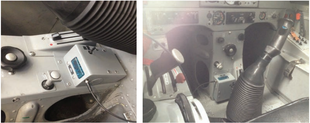
Figura 4 – Localização do conjunto, suporte e acelerómetro MSR 165, a) Vista geral, b) Vista pormenorizada
