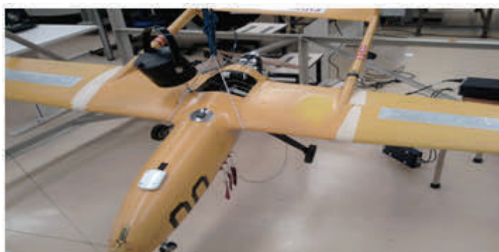
Figura 8 – Alpha-Extended completo suspenso para análise experimental
